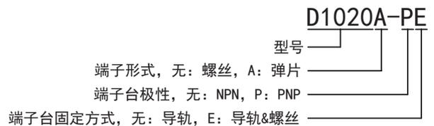
注：带 E 安装左右中心距 = 端子台长度 + 7.7mm
